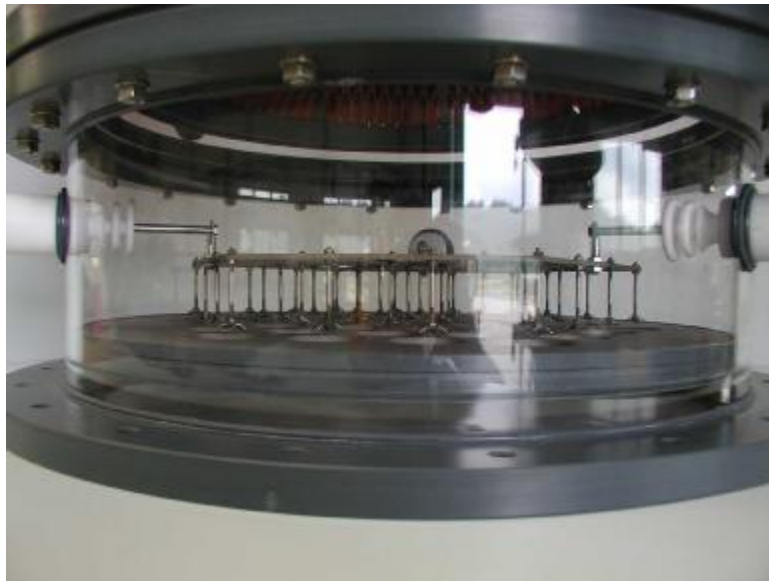
Abb. 2: Ionisatorstufe eines Carola-Abscheiders (700 m 3 /h Gasdurchsatz)
