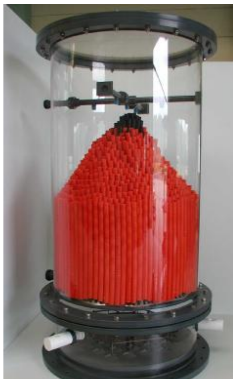
Abb. 1: Modell einer Carola-Einheit für einen Gasdurchsatz von 700 m 3 /h
